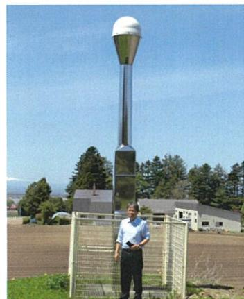
図2 電子基準点（北海道長沼）
